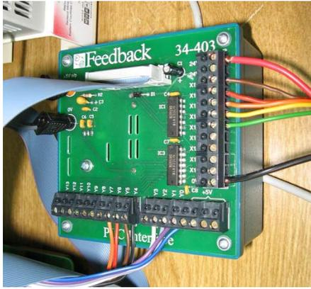
Fig.4. Module Feedback 34-403
